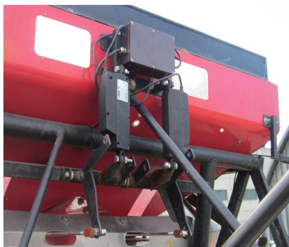
Вариант компоновки блока управления с актуаторами на бункере разбрасывателя
